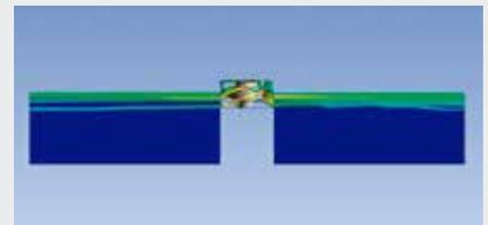
Esta visualización CFD muestra cómo el flujo de aire se adhiere virtualmente a los bastidores del servidor sin generarse turbulencia alguna. El aire frío fluye directamente frente a los bastidores del servidor.
