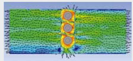
Las zonas en rojo – alrededor de los ventiladores EC – muestran que en las salidas de éstos se emite el aire frío a una velocidad muy elevada (aprox. 9-11 m/s). Sin embargo, éste solo sería el caso siempre que se tratara del aire dentro del alojamiento. Las particiones instaladas entre los ventiladores EC canalizan el flujo de aire y los deflectores de aire de la salida aseguran una distribución uniforme a lo largo de toda la altura de los bastidores.
